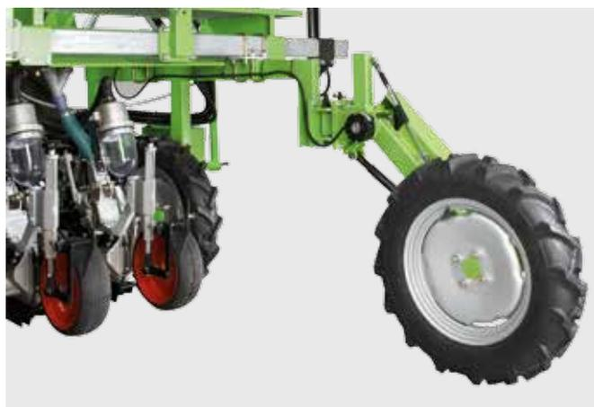
Измерительное колесо с телеметрическим датчиком
