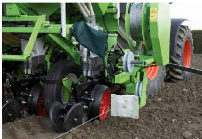
Тросовая система управления с механизмом размотки
