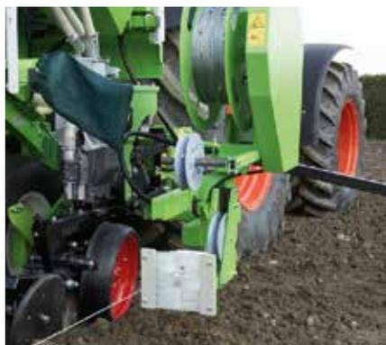
Тросовая система управления с механизмом размотки
