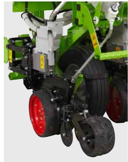
Компактное размещение электропривода на высеваящем элементе
